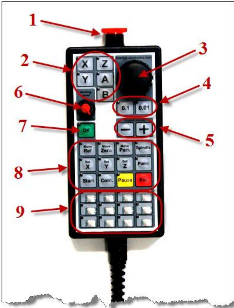
1. Der NOT-AUS-Schalter stoppt die Arbeit der Maschine sofort. Gleichzeitig wird die Stromversorgung der Elektronik abgeschaltet.
