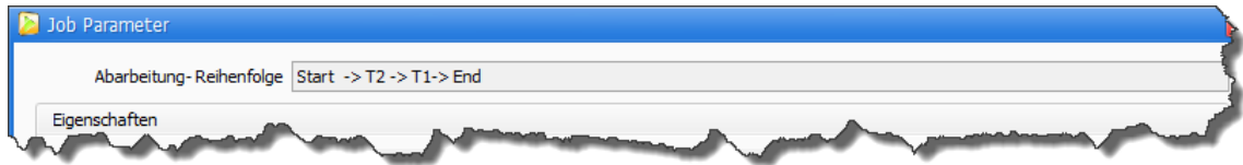
Abbildung 2: Im folgendem Beispiel werden zuerst Arbeiten mit Werkzeug T2 und danach mit Werkzeug T1 durchgeführt.
